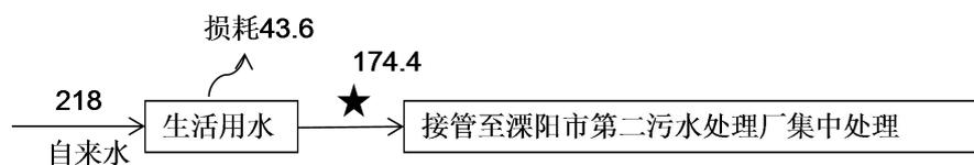
图 2-1 本项目水量及水平衡图 (t/a)
